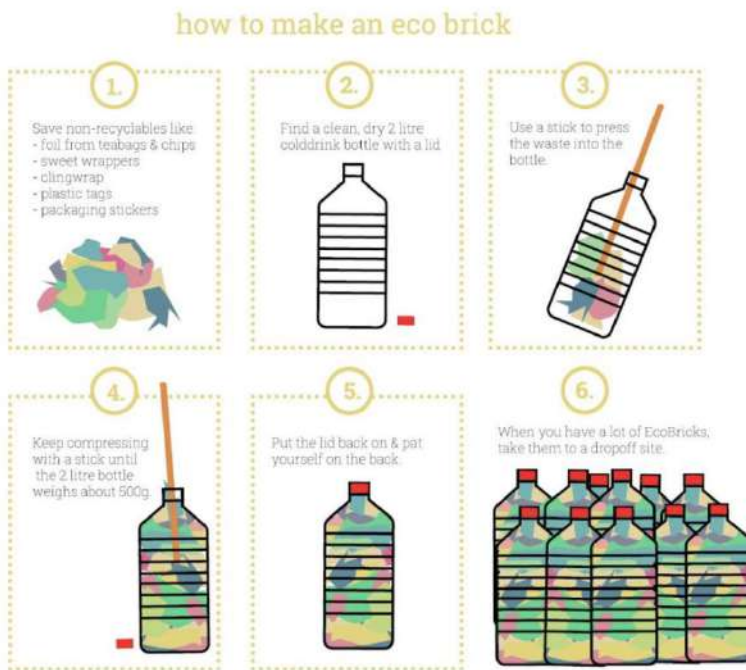
Gambar 5.11. Cara membuat ecobrick
